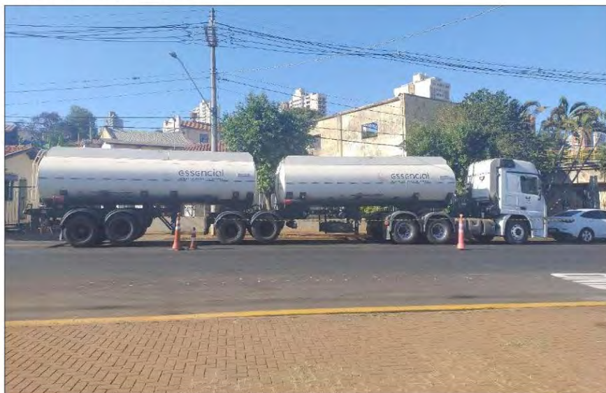
Foto 32 – Carreta tanque com capacidade de transportar 45m 3 de efluente, carregando pela base da ETA2, na Avenida Beira-Rio, em 06/Ago/2024.
