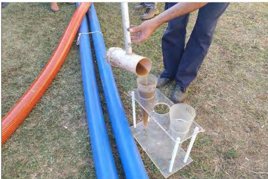
Foto 17 – Análise da quantidade de sedimentos no efluente retirado da base do decantador (Cone de Sedimentação Imhoff) (03/Ago/2024).
