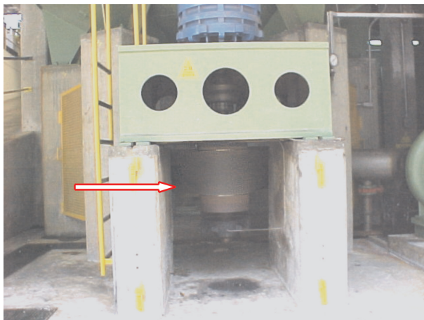
Foto 7-A: Motor elétrico de acionamento do hidrapuper ANTES : Correia do motor sem proteção (item 1.2.3.)
