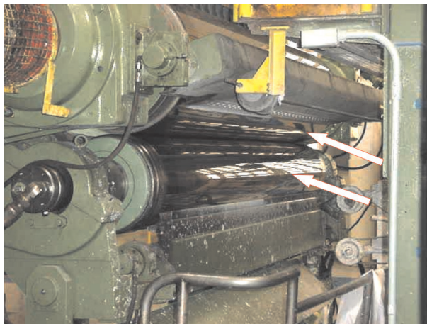
Foto 21 : Calandra - Cilindros convergentes e partes móveis representam risco na alimentação manual do papel ( item 6.1.1. )
