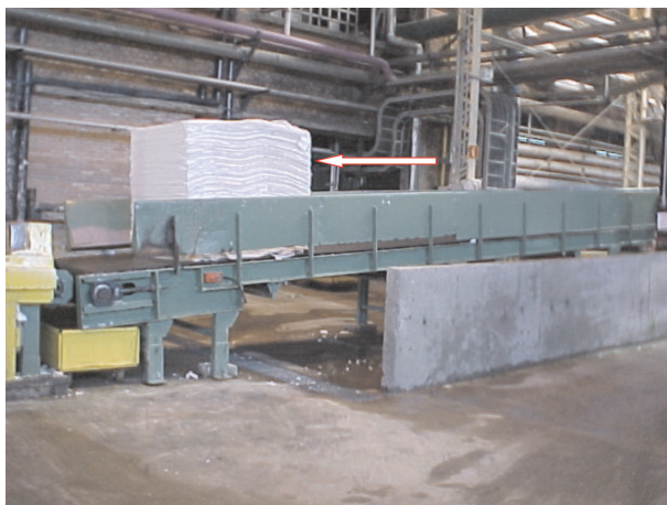
Foto 3: Transporte do fardo para o hidrapulper por esteira mecânica (item 1.1.2)
