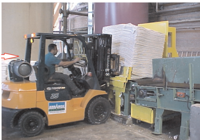
Foto 2: Alimentação da esteira de hidrapulper por empilhadeira (item 1.1.2.)
