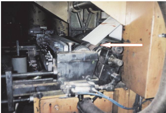
Foto 36: Risco de acidentes parte móveis (conjunto impressor). (item 11.2.2.)
