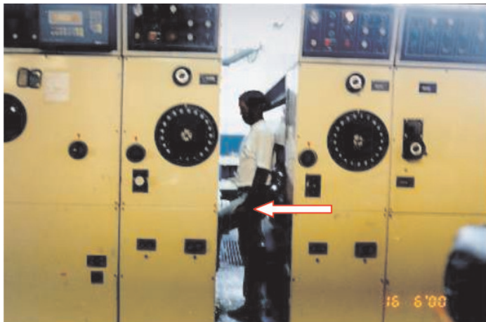
Foto 38: Risco de Acidentes partes móveis ou esmagamentos devido à possibilidade de acionamento acidental com o trabalhador posicionado no interior da máquina (item 11.2.5.)
