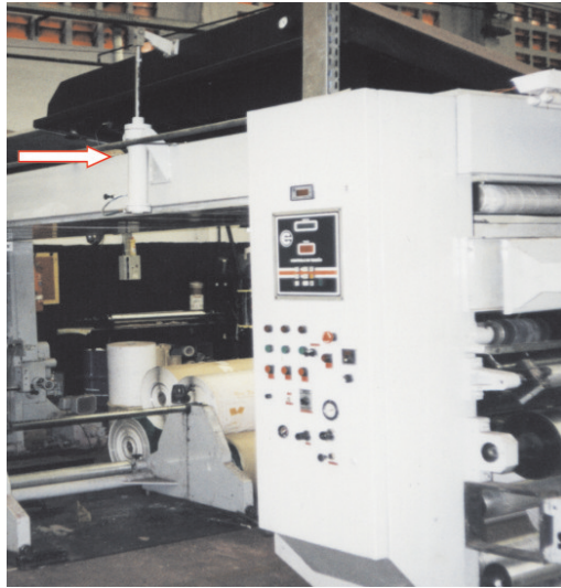
Foto 41: Risco de Queimaduras (estufa com resistência ). ( item 12.2.2.)
