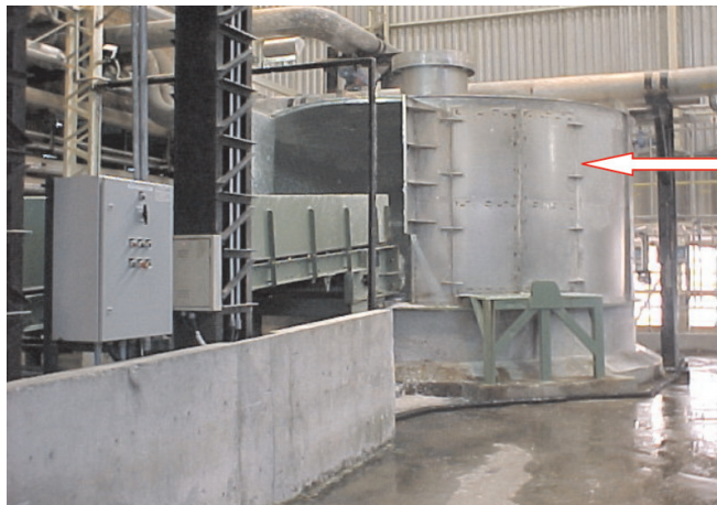
Foto 1: Hidrapulper: grande semelhança com um liquidificador, utilizado para desagregar fardos de celulose e aparas no processo de fabricação do papel (item 1.1.1.)
