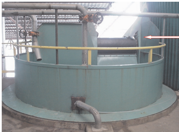
Foto 6: Risco de queda do hidrapulper - observe proteção parte superior (item 1.2.2.)
