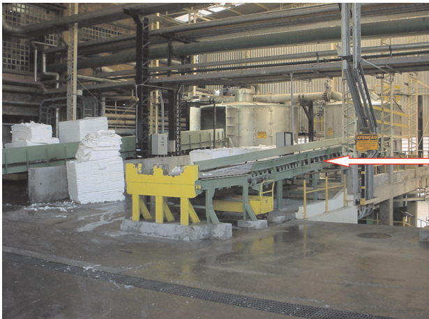
Foto 9 : Esteira de Alimentação do Hidrapulper - Risco de esmagamento entre os roletes (item 1.2.5.)
