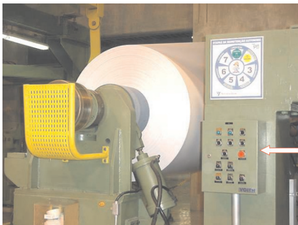
Foto 27: Rebobinadeira - Parada de emergência através de botoeiras (item 8.3.3.)
