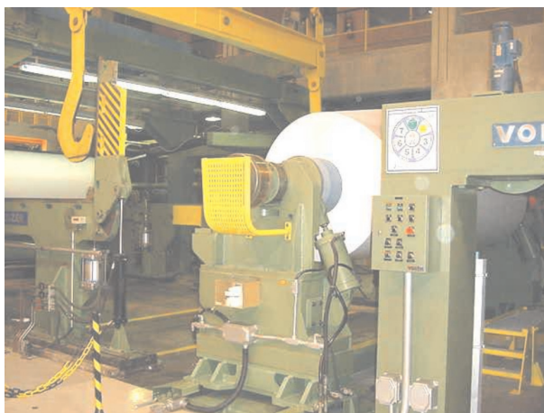
Foto 26: Sistema de retirada de bobina através de pontes rolantes ( item 8.2.4. )
