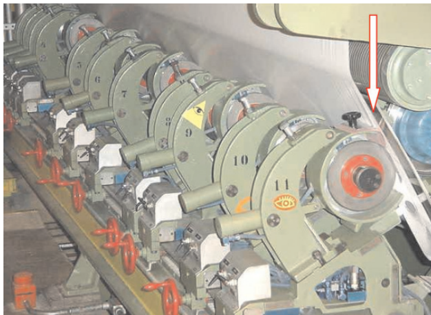
Foto 25: Facas giratórias de cortes - providas de proteção junto às lâminas (item 8.2.1. e 8.3.2.)
