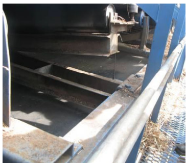
Foto 1 – esteira desprotegida que gerou acidente com trabalhador de 21 anos que durante suas atividades caiu em partes móveis da esteira. O registro do acidente gerou ações do Cerest, MPT, MTE, Sindicato.
