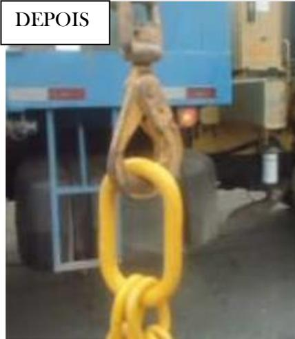
Sistema de gancho fechado adotado após o acidente, evita que o gancho escape.
