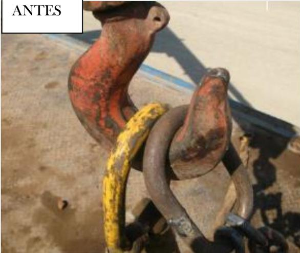
Sistema de gancho adotado no dia do acidente permite que os ganchos da corrente e cinta escape
