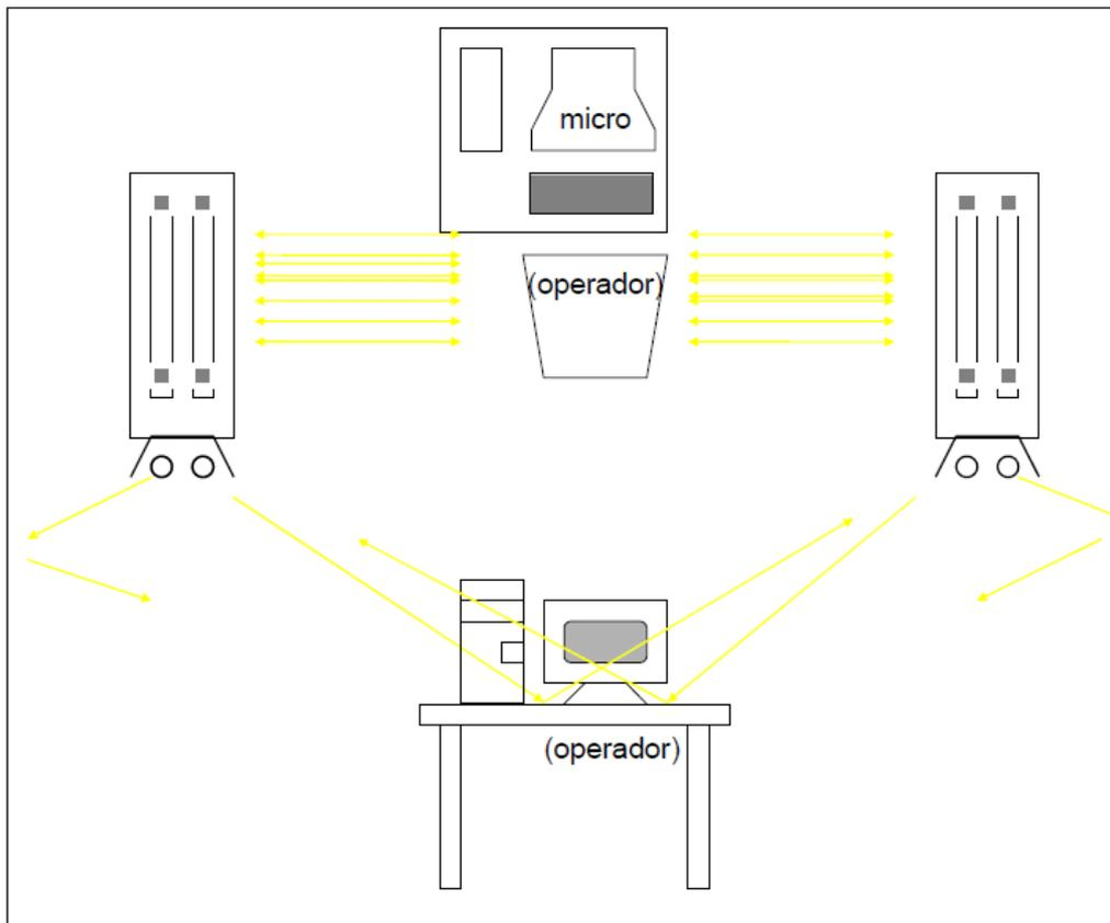
*A reflexão de luz proveniente de lâmpadas colocadas lateralmente ao operador no posto de trabalho não incide em sua linha de visão.*
