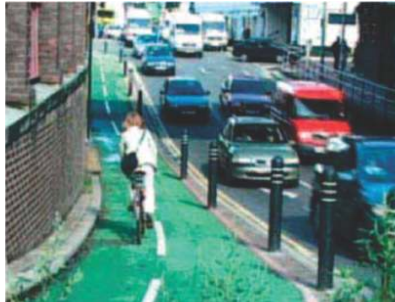
Ciclovia separada do tráfego motorizado por espaço, pinturas e ciclolitos Londres, 2006. Foto I-ce.
